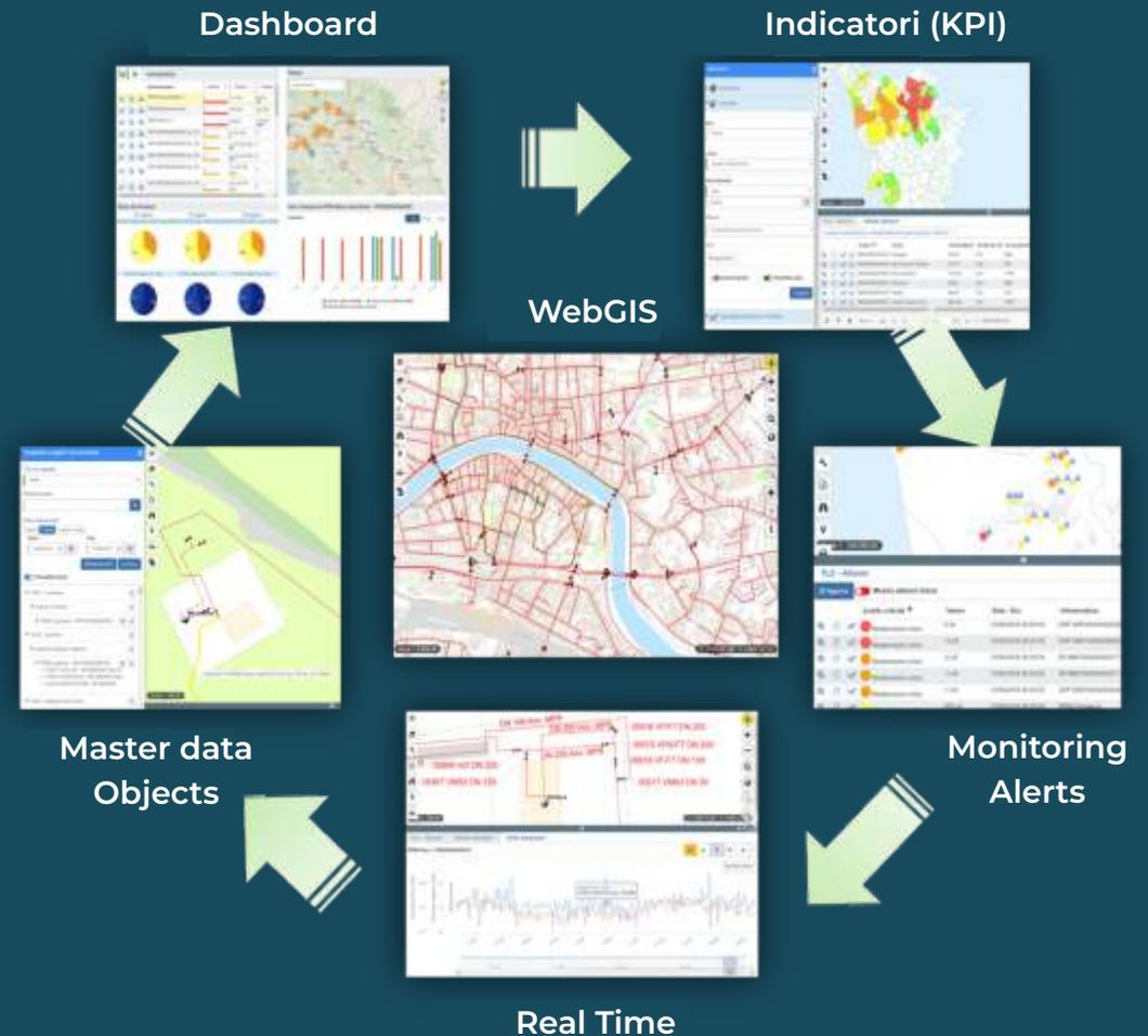
SITAcqua prevede un modello dati GIS-centrico ed un'architettura Service Oriented, con servizi lato server di elaborazione dati, integrazione di applicazioni e funzionalità end-to-end, nonché moduli applicativi basati su ArcGis fruibili su desktop e via web da ogni canale.
